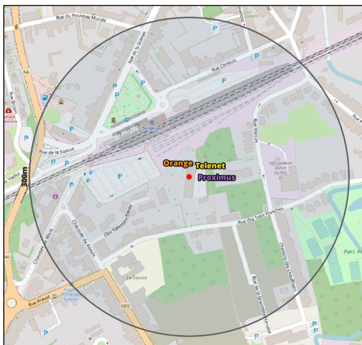
Figure 2 : Vue en plan des installations d'antennes dans un rayon de 300 mètres autour de l'installation faisant l'objet de la demande d'avis
