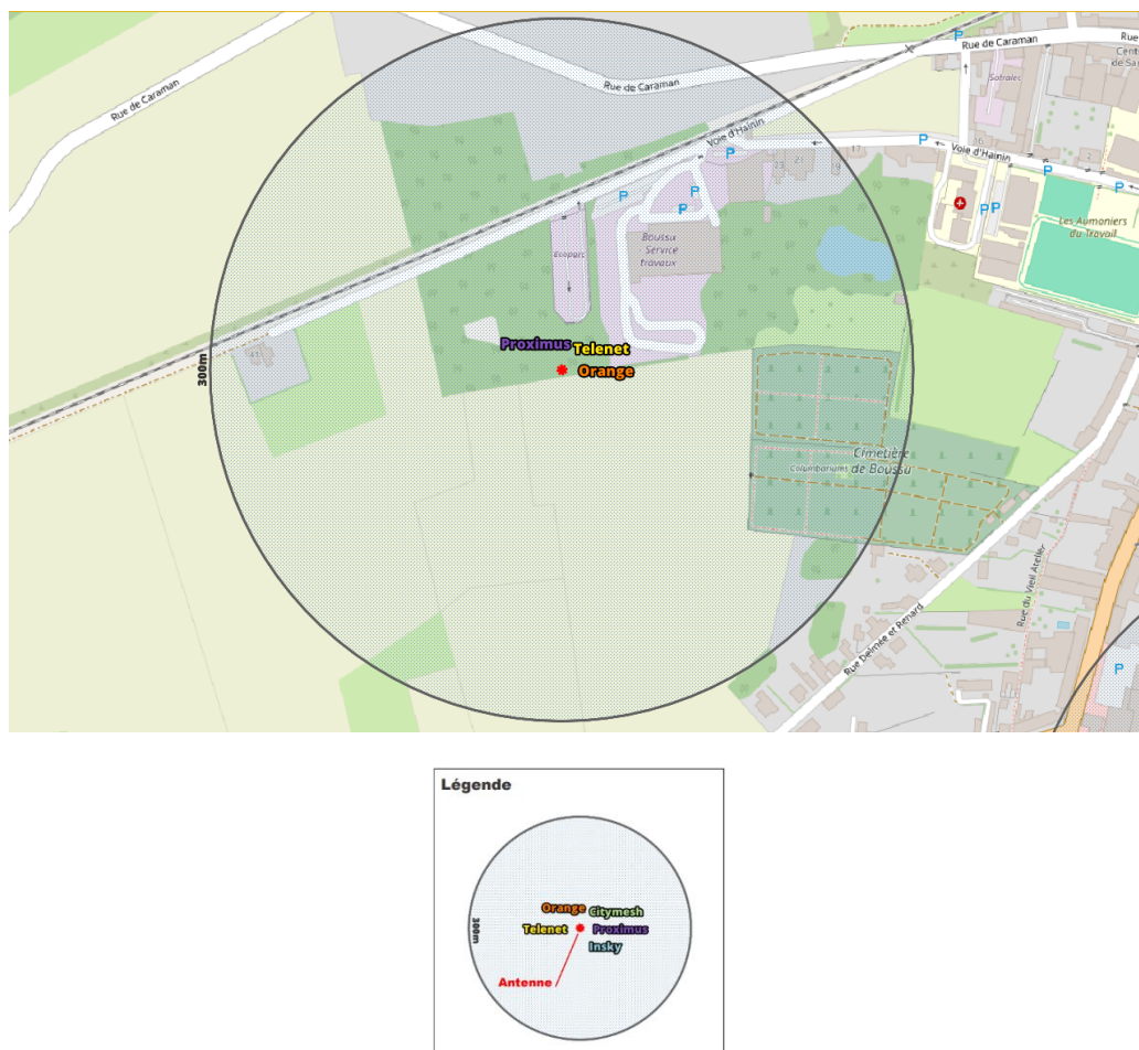
Figure 2 : Vue en plan des installations d'antennes dans un rayon de 300 mètres autour de l'installation faisant l'objet de la demande d'avis
